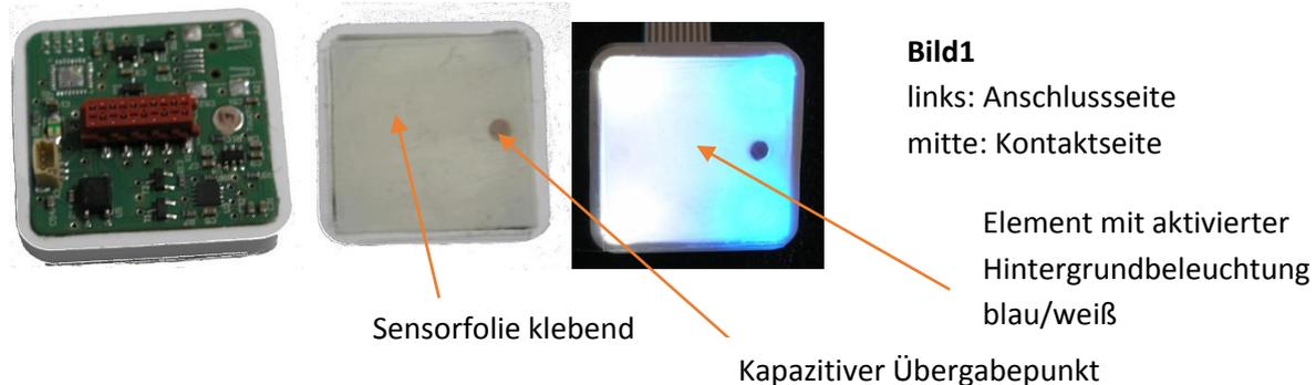
Jede Taste besitzt einen eigenen Mikrocontroller, über den programmtechnisch die Schaltfunktion (Schalter, Taster, Zeitschalter etc.) festgelegt werden kann. Ebenso die Funktion der Hintergrundbeleuchtungen. Für den Anwender steht ein normaler Schaltkontakt (open Collector), eine adressierbare serielle Schnittstelle und ein USB-Port zu Verfügung.
