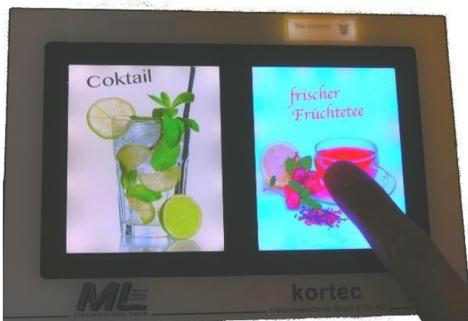
Eingabetafel mit Betätigung und Farbumschlag
